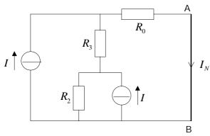
Pour calculer le courant de Norton (ou courant de court-circuit), nous allons appliquer encore une fois le **théorème de superposition**. En éteignant la source de courant qui est en parallèle sur la résistance  $R_2$ , on obtient le circuit équivalent :
